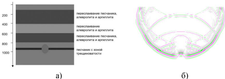
Рис. 1. Обобщенная модель разреза углеродного массива (а) и мгновенная картина распространения SH волн (б) для участка «Кальмиусский Рудник» поля шахты «Им. А.Ф. Засядько»
