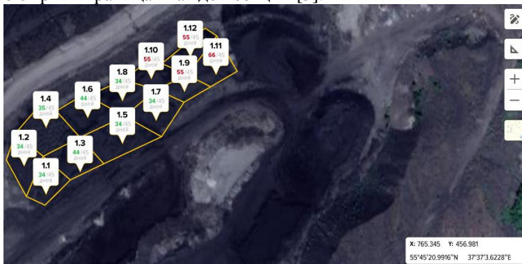
Рис. 1. Секционное складирование полезного ископаемого
