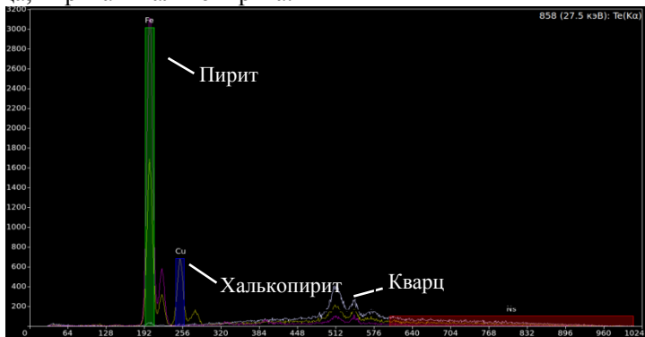
Рис. 2. Спектры различных кусков, полученных с помощью рентгенофлуоресцентного сепаратора: белый – кусок с преобладанием кварца, малиновый – кусок с преобладанием пирита, желтый с преобладанием халькопирита
